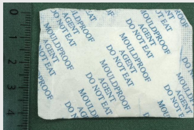
Bild 2. En av de små påsar som hittades i en soffa. När vi analyserade innehållet kunde vi konstatera att den var fylld med dimetylfumarat.
