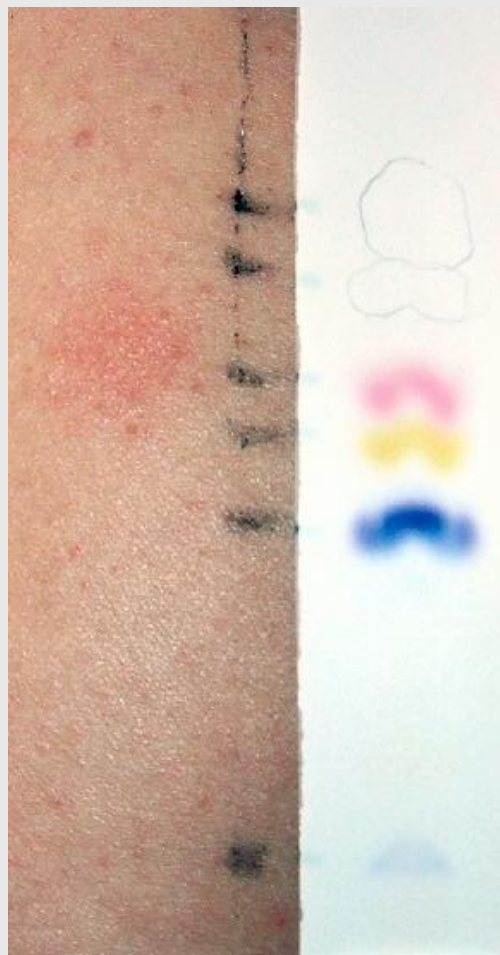
Bild 1. Tunnsiktsskromatogram har testats och givit en positiv testreaktion. Här jämförs testreaktionen med en kopia av det testade skromatogrammet för att fastställa var på skromatogrammet allergenet finns.
